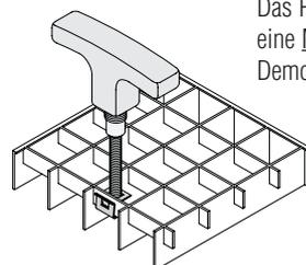
Das Positionierwerkzeug ermöglicht eine Montage von oben, ohne eine Demontage des Gitterrosts.
